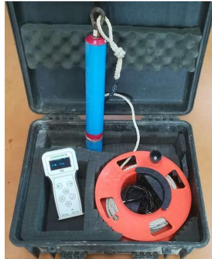
Développés par les sociétés SIMI et OXILEC, les appareils DIADEME4 et CONFOR'S sont destinés aux contrôles des forages des tirs de mines :
